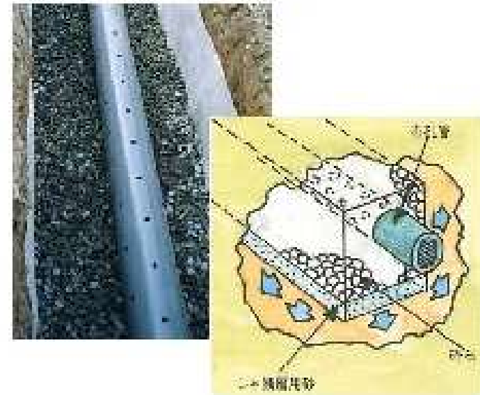
浸透トレンチ
