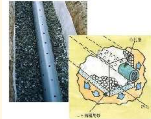
浸透トレンチ
