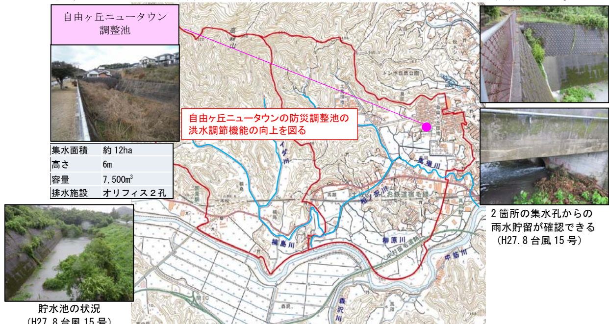
図 3.8 事業概要（雨水貯留施設の有効活用）
