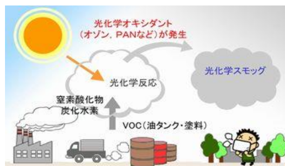
図 3-10 光化学スモッグの発生メカニズム
